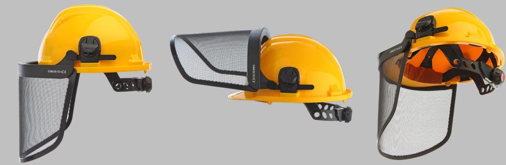
La pantalla facial 436-M ha sido diseñada para ofrecer protección en trabajos forestales, de jardinería, tala y corta, desbrozado u otras actividades afines que requieran protección conjunta de la cabeza, ojos y rostro. El conjunto se compone de casco y rejilla abatible con anclaje para casco. Su especial diseño limita mínimamente el ángulo de visión lateral y permite una perfecta adaptación a las diferentes fisionomías de los usuarios, gracias al mecanismo de ajuste del sistema de sujeción.
