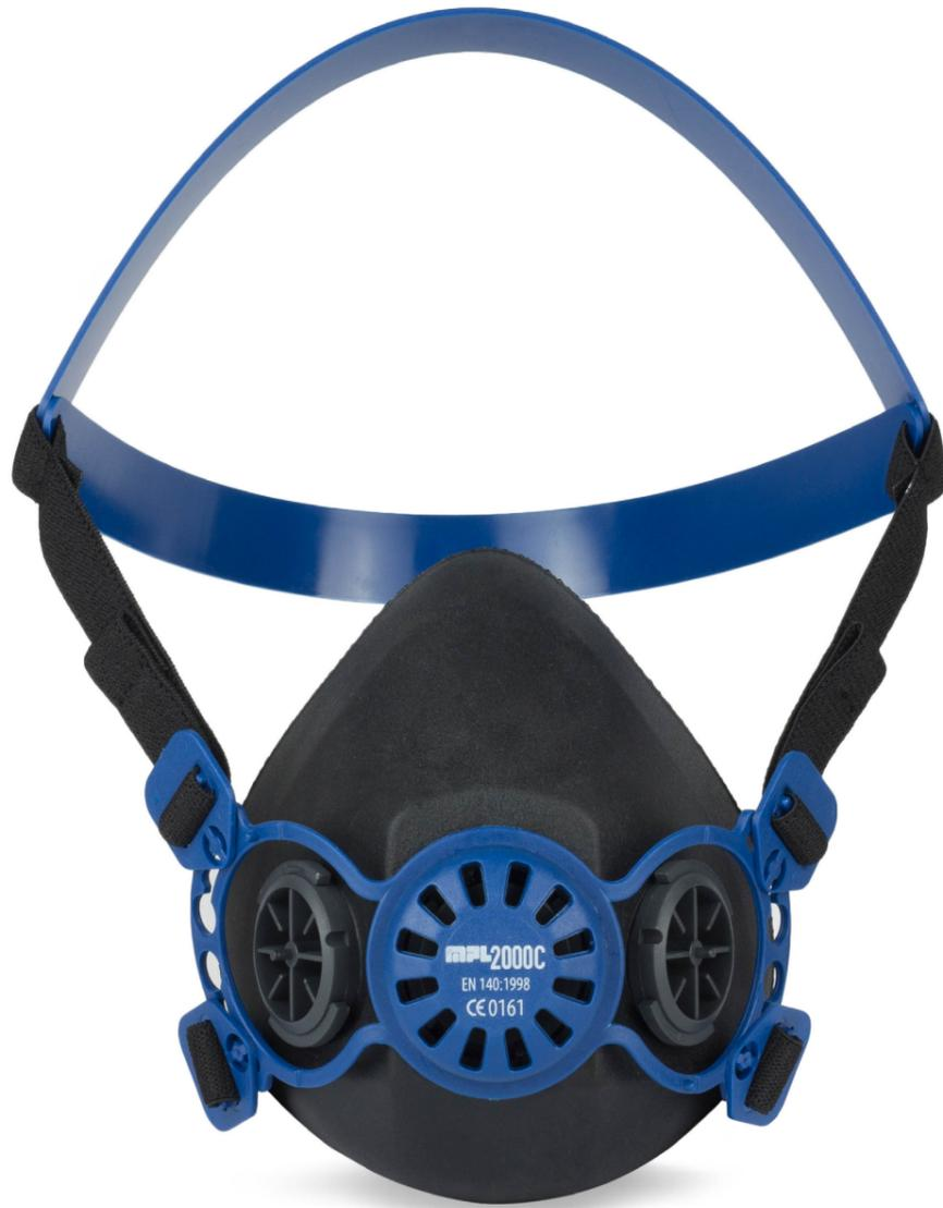
Las medias máscara reutilizables **Series 2000** están diseñadas para ser utilizadas con filtro doble, y para ofrecer al usuario máximo confort y durabilidad. Con el filtro adecuado, proporcionan protección contra partículas y una amplia variedad de gases y vapores.
